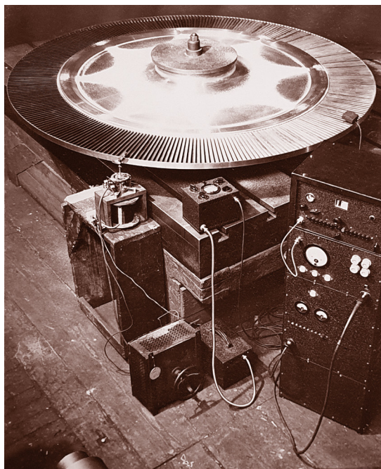
Obr. 13 Přístroj pro měření vlastních kmitů strojních součástí. Zde při zkoušení oběžného kola turbíny (o průměru cca 1 m). Pro zobrazení kmiten a uzlů jsou použity i Chladniho obrazce ukazující uzly kmitů (osmicípý obrazec ze světých částic na střední části kola). Zdroj: MÚA AVČR, fond ÚÚF – fotografie se zde nachází bez popisu, takže výše uvedený popis je interpretace autora článku
