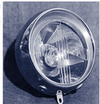
Obr. 16 Prototyp asymetrického světlometu spolu s výstřižkem z denního tisku. Zdroj: Archiv AV ČR
